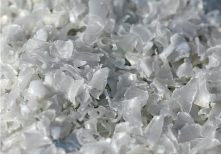
**Alle gesammelten PET-Flaschen werden zu Rezyklat verarbeitet. Nach der Reinigung und Wiederaufbereitung dieser «Schnipsel» kann man damit viele nützliche Dinge herstellen. (Foto: PET-Recycling Schweiz)**
